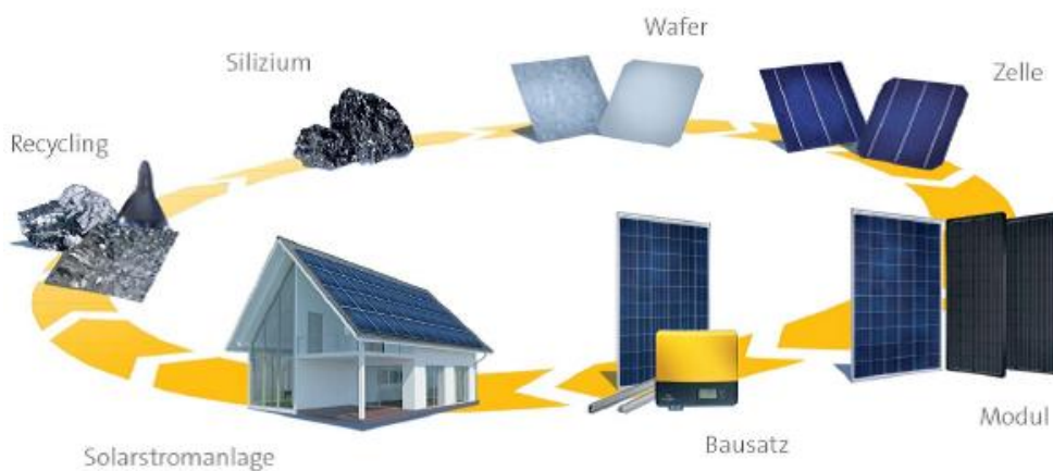
Abbildung 9: Von Sand zu Strom: Wertschöpfungskette der kristallinen Silizium-Photovoltaik nach aktuellem Stand der Technik 16
