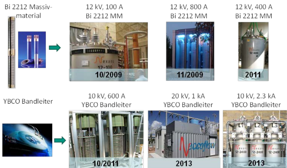
Abbildung 18: Übersicht über ausgeführte resistive Mittelspannungsstrombegrenzer 91
